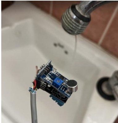
รูปที่ 6 เซนเซอร์วัดความดังของน้ำที่รั่วซึม จากตำแหน่งที่ 1 ก๊อกน้ำ
