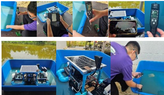
รูปที่ 6 การทดลองระบบการทำงานของเครื่องเฝ้าระวังระบบนิเวศในบ่อน้ำสาธารณะ
