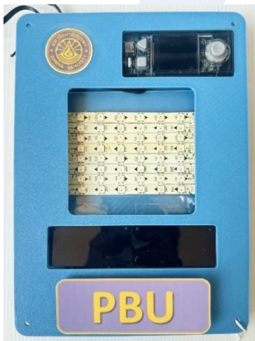
รูปที่ 2 เครื่องแจ้งเตือนค่าฝุ่น PM2.5 อัตโนมัติโดยใช้ CyberPi
