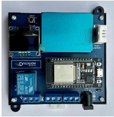
รูปที่ 1 เซนเซอร์วัดค่าฝุ่น (ชุดบอร์ดพัฒนา Dustation Dev Kit V.2 / PMS7003 ESP32 OLED AM2302)
