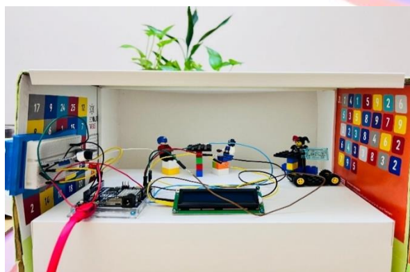
รูปที่ 4 ห้องจำลองติดตั้งระบบแจ้งเตือนสถานะเสียงด้วย Arduino R4
