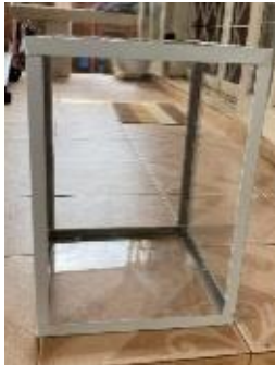
รูปที่ 3.2 การนำแผ่นอะคริลิกที่ทำน้ำยาแล้วมาประกอบเป็นรูปทรงกล่อง
